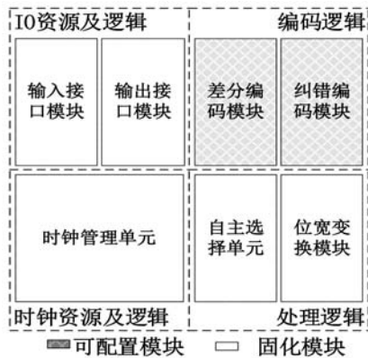
图4 星载数传调制器软件组成框图
