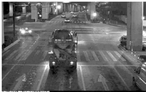
图 1 镜头和补光未正确配置情况
